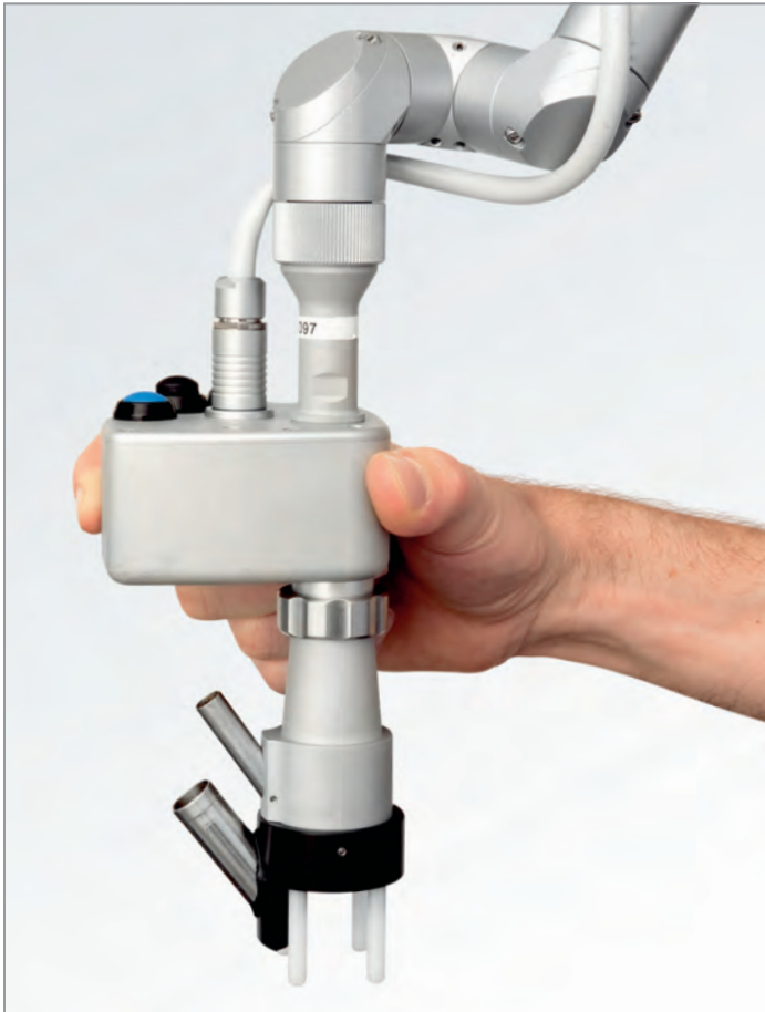
Abb. 5.52 Gelenkarm eines Stempelscanners sowie Zuführung von Kaltluft (großer Schlauchansatz unten) und Absaugung (kleiner weißer Schlauchansatz oben).
